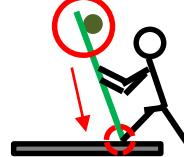
足で支柱を支えながら差し込むと、支柱を曲げずに、効率よく立てられます
